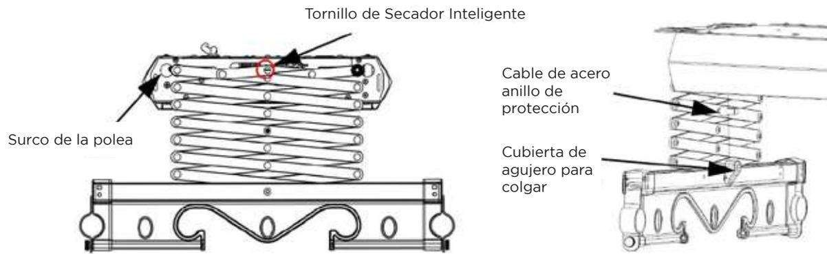
Atornille con los tornillos del Secador Inteligente. La cabeza de la cuerda de acero debe pasar a través del anillo de protección de cuerda de acero, luego conecta el orificio para colgar en la placa de montaje de varillas y coloque la tapa en el orificio para colgar, como se muestra en la imagen anterior.
