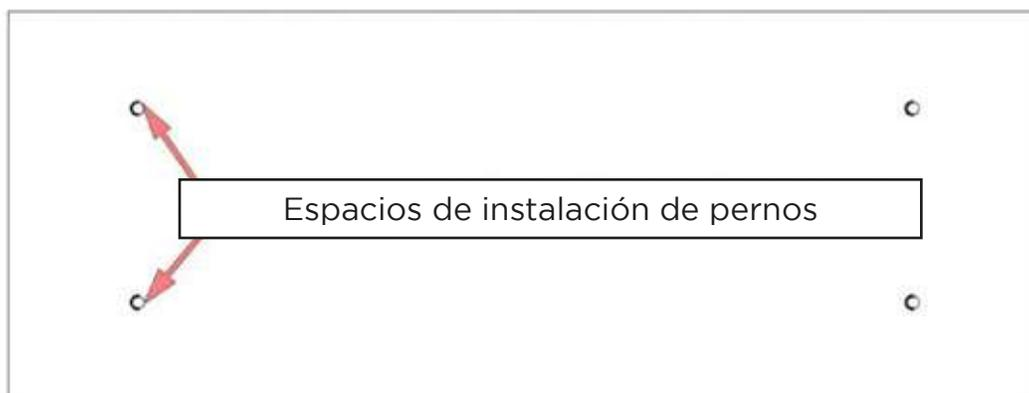
4) Perfore 4 orificios de 10 x 80 mm con un taladro de percusión, ajuste el tornillo de fijación en la tuerca M10 antes de poner el tornillo de fijación en el techo.
